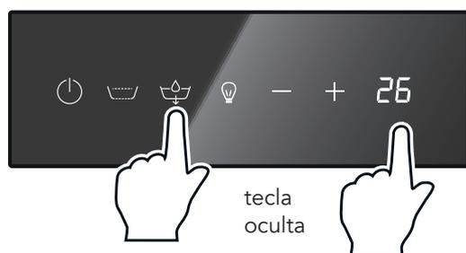
Para evitar el vaciado accidental de la bañera, se requiere una combinación de dos teclas para llevar a cabo esta operación:
