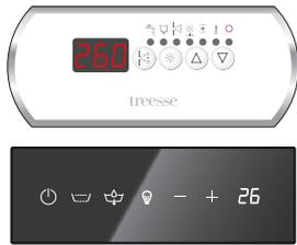
La **minipiscina** se enciende conectándola a la red eléctrica. Cuando se enciende el equipo, todos los leds/teclas se iluminan durante 3 segundos, a continuación se muestra la versión (Fxx, p.ej. F01) y la revisión del firmware (ryy, p.ej. r05).
