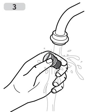
LIMPIEZA DE FILTROS • NETEJA DE FILTRES • NETTOYAGE DES FILTRES • REINIGUNG DER FILTER •
