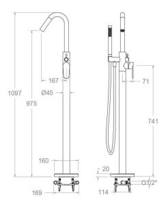
Monomando de columna para baño, fijación Tecnobox02, con equipo de ducha
