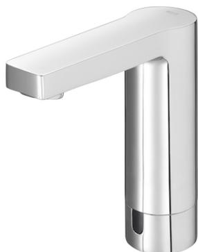
Grifería electrónica para lavabo (un agua) con limitador de caudal. Alimentación con 4 pilas alcalinas 1,5V LR6 (AA).
